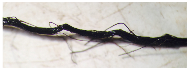
afbeelding 18, inslagdraad uit V7 met deuken van de kettingdraad.
